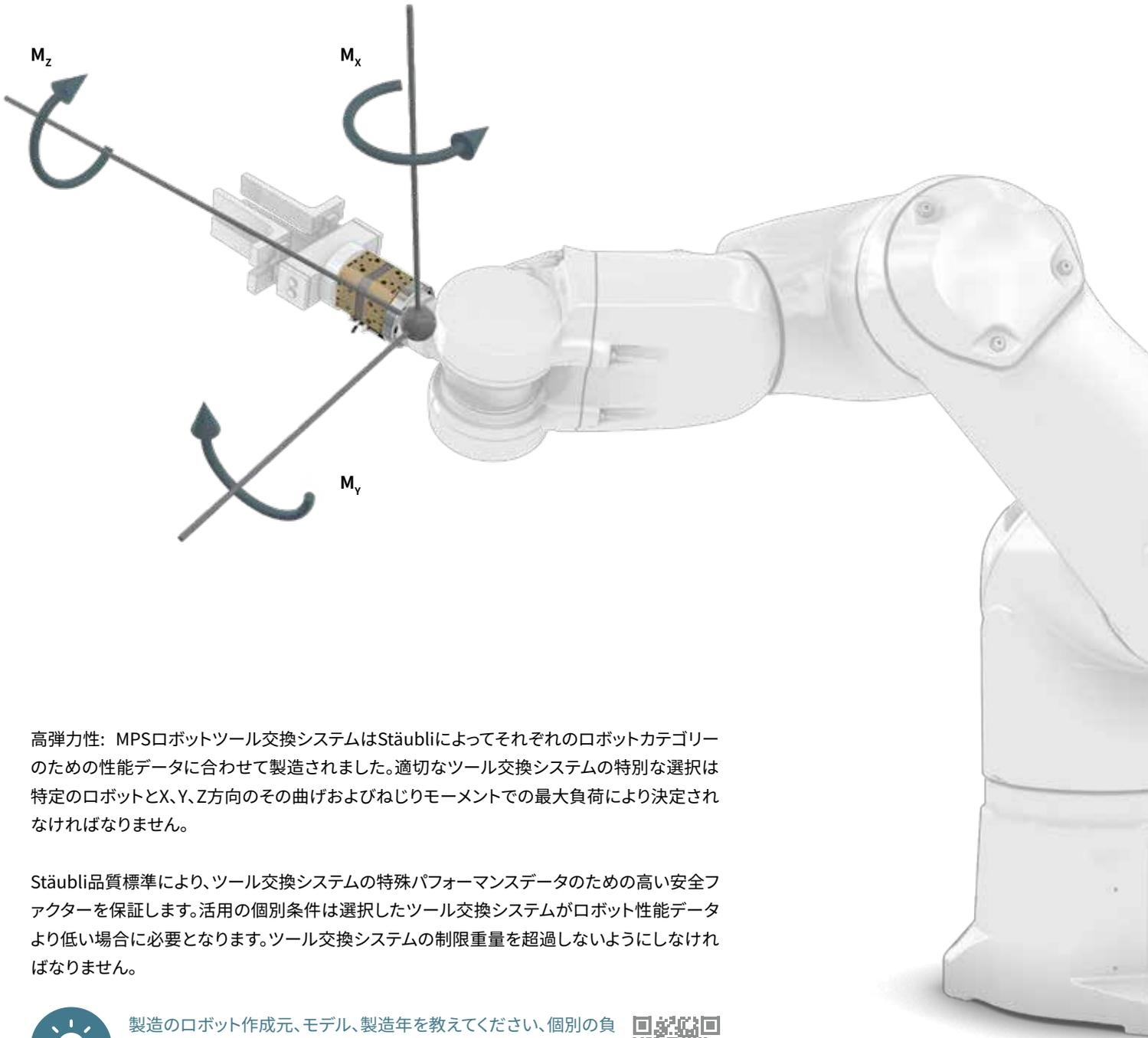
高弾力性: MPSロボットツール交換システムはStäubliによってそれぞれのロボットカテゴリーのための性能データに合わせて製造されました。適切なツール交換システムの特別な選択は特定のロボットとX、Y、Z方向のその曲げおよびねじりモーメントでの最大負荷により決定されなければなりません。
